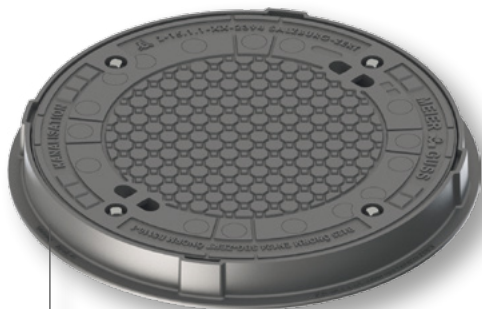
Właz kanałowy klasy D 400 z uszczelką na całym ob- wodzie i 4 śrubami
