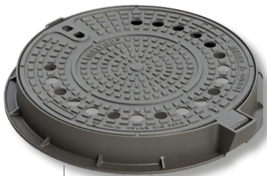
Właz kanałowy klasy D 400, seria MEITOP®, SFERO, wentylowany, z wkładką tłumiącą, zawiasem i dwoma zatrzaskami (104 370)
